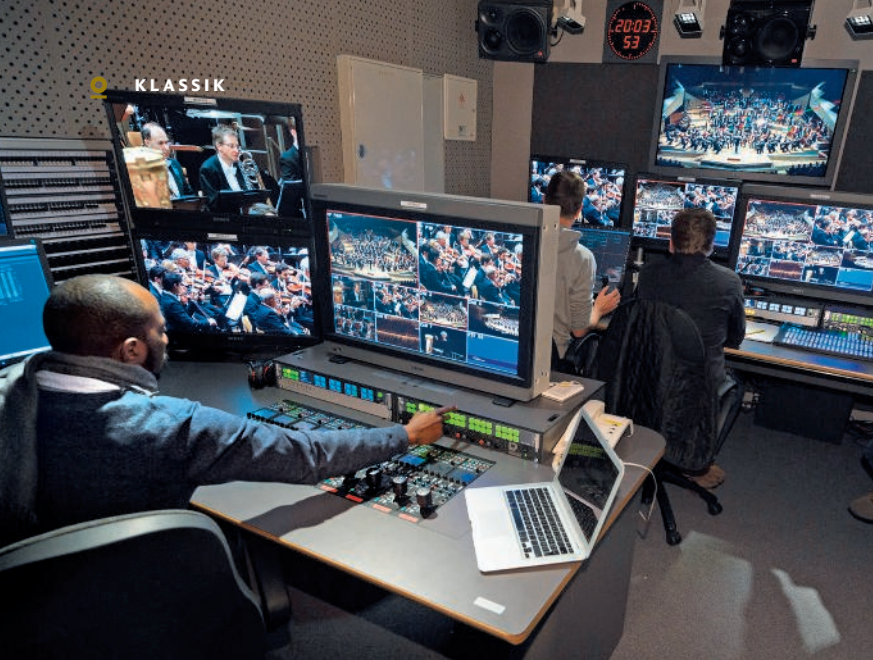
Das zweite Pult: Sieben Kameras zeichnen das Geschehen im Saal auf, gesteuert werden sie aus dem Studio unterm Dach
